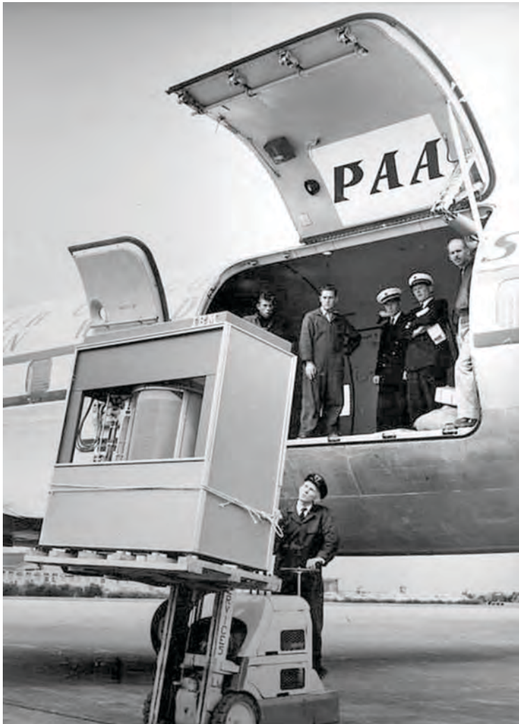
Unidad de memoria de disco RAMAC de IBM, de 4.2 Mb de capacidad- 1957. Pesaba una tonelada. Foto por David Bennet. © international Business Machine Corp. Imagen por cortesía de International Business Machine Corp.
