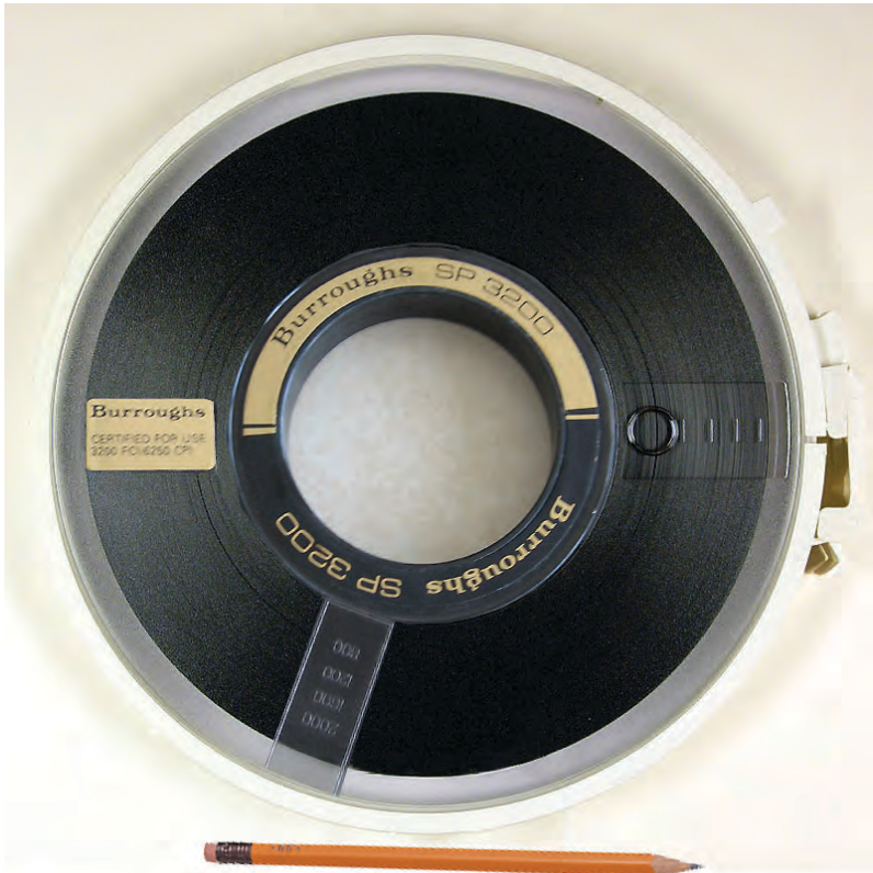
Cinta magnética para almacenamiento de datos 2,400 pies. Su capacidad máxima era de 22 MB. Años setenta. UNAM CC BY-NC-SA 3.0 ESP
