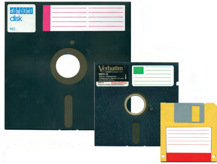
Izquierda: Disquete de 8 pulgadas = 20 cms. (70's). Centro: Disquete de 5 1/4 pulgadas = 13 cms. (80's). Derecha: Disquete de 3 1/2 pulgadas = 9 cms (90's). 1Mb, 1.2Mb, 1.44Mb máximo respectivamente. Imagen UNAM CC BY-NC-SA 3.0 ESP
