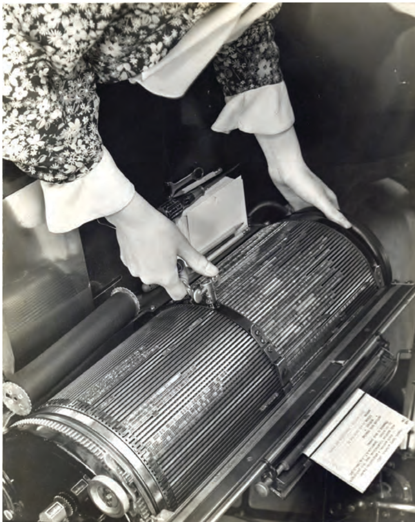
Multigrafo de la Biblioteca Pública de Cleveland, Mayo de 1937. Utilizado para la producción masiva de tarjetas de catálogo. El Multigrafo era una antigua máquina copiadora mecánica que tenía la capacidad de reproducir cartas que parecían estar mecanografiadas. Imagen por cortesía de los Archivos de la Biblioteca Pública de Cleveland, EUA.
