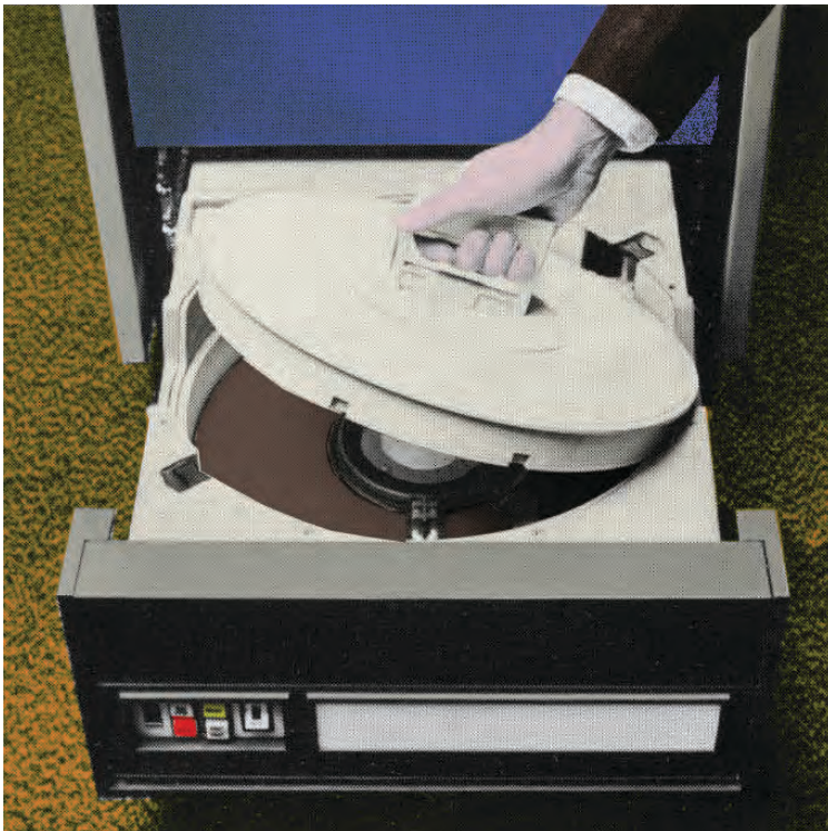
Disco duro removible con capelo, UNIVAC CADE-1900, 1978. 2.2 MB.
