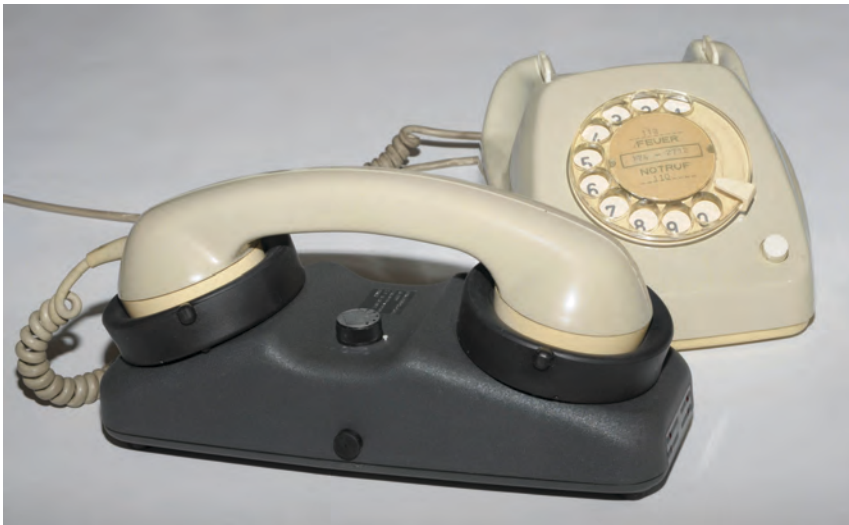
Acoplador acústico para envío de datos a través de una línea telefónica común, ca. 1980. By Hubert Berberich (HubiB) Own Work, dominio público, vía Wikicommons. https://commons.wikimedia.org/w/index.php?curid=14702242
