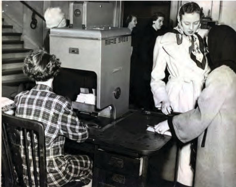
Máquina Recordak. Hacia 1940, los usuarios de la Biblioteca Pública de Cleveland ya no necesitan escribir su número de credencial en la tarjeta. En su lugar, un asistente en el mostrador de préstamo fotografiará instantánea y simultáneamente la tarjeta del usuario, la tarjeta del libro y una nueva fecha de vencimiento en el microfilm. Imagen por cortesía de los Archivos de la Biblioteca Pública de Cleveland, EUA.
