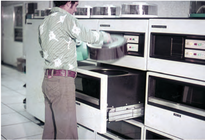
Introduciendo un "disk pack " o paquete de discos en su unidad lectora. Computador Burroughs B-6700 de la UNAM, ca. 1974. UNAM - DGTIC http://historiadelcomputo.unam.mx CC BY-NC-SA 3.0 ESP
