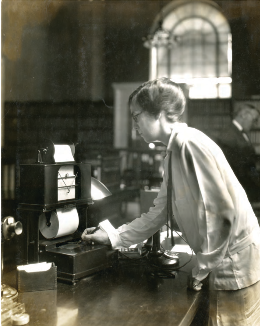
Empleada de la biblioteca que usa el teleautógrafo hacia 1925. El teleautógrafo fue un antiguo precursor de la máquina de fax, y reproducía información escrita a mano mediante la transmisión de impulsos eléctricos de una estación a otra. Imagen por cortesía de los Archivos de la Biblioteca Pública de Cleveland, EUA.
