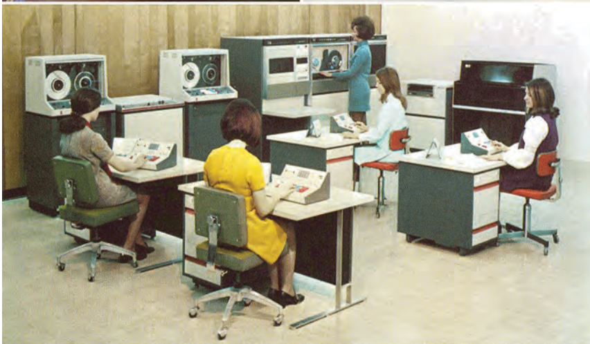
Tres ejemplos de sistemas key-to-tape o captura directa a cinta magnética sin tarjetas perforadas, ca. 1970. 1) Datascribe de Vanguard 2) Libra de International Data Sciences. 3) MDS-2400 de Mohawk. Nótense los teclados y las unidades de cinta magnética.
