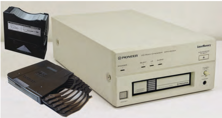
Cambiador Pioneer de cd-rom con dos cartuchos para seis discos. 1991. UNAM CC BY-NC-SA 3.0 ESP
