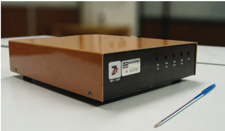
Módem Transdat MFX - 30 a 180 caracteres por segundo, ca. 1977 Imagen UNAM CC BY-NC-SA 3.0 ESP
