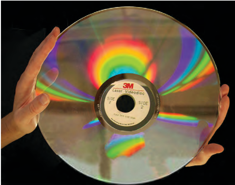
Videodisco láser de 12 pulgadas para datos, de tipo analógico. Fue el antecesor del cd-rom en los años ochenta. CC BY-NC-SA 3.0 ESP
